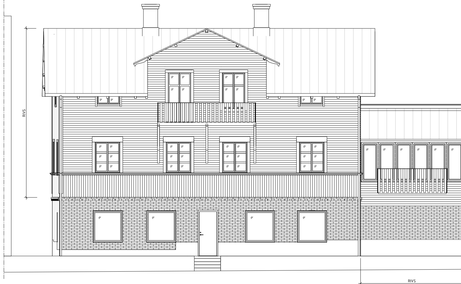
Fasad mot Söder -Befintlig 1 : 50
